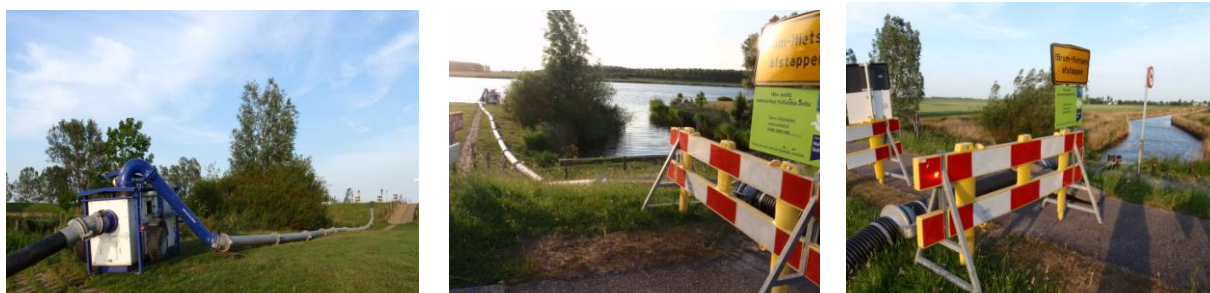
Water tekort in de Hoeksche Waard, waterschap pompt water uit het Spui in de oude haven van Piershil.
